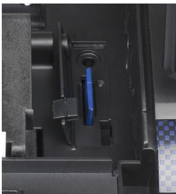
Zur Programmierung, Datensicherung und Erfüllung der gesetzlichen Auflagen ist die ER-900er Serie mit einem SD-Kartenslot ausgestattet, der so entwickelt und positioniert ist, dass er vor unberechtigtem Zugriff geschützt ist.
