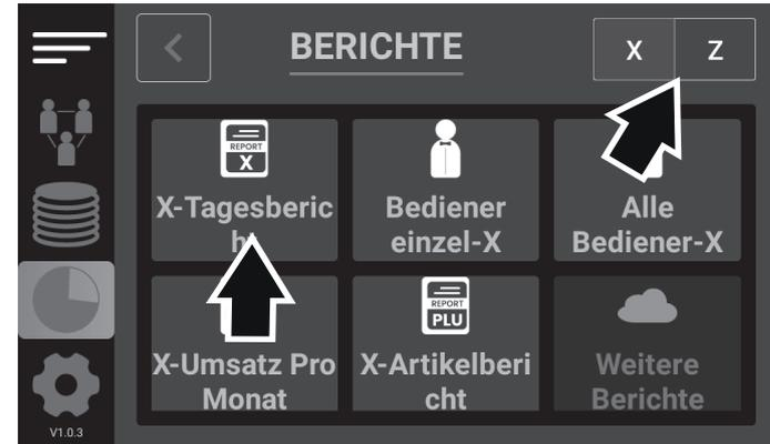
**HINWEIS:** Ist die Registrierkasse mit einem externen Speichermedium oder der Cloud verbunden, wenn Sie einen z-Tagesbericht drucken, werden die Fiskaldaten auf das Speichermedium oder in die Cloud exportiert.
