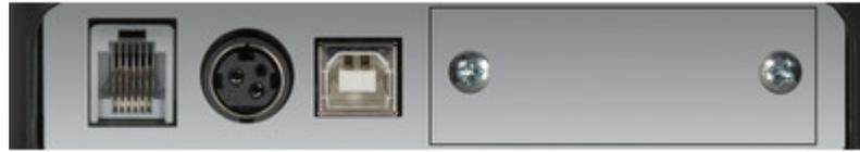
Standardmäßig mit USB 2.0 ausgestattet, sind Schnittstellen je nach Bedarf für Ethernet LAN, Seriell, WiFi und Bluetooth optional verfügbar.
