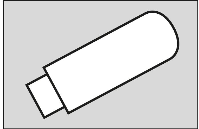
Der TSE-Stick inklusive technischer Sicherheitseinrichtung wird über einen der USB-Anschlüsse an der Registrierkasse angeschlossen. Der TSE-Stick hat eine begrenzte Nutzungsdauer (siehe „Nutzungszeitraum des TSE-Sticks prüfen“ auf Seite 27). Fällt der TSE-Stick aus oder erreicht das Ende der Nutzungsdauer, muss umgehend ein neuer TSE-Stick an der Registrierkasse angemeldet werden.
