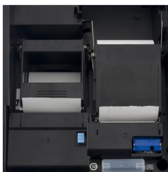
Der Drucker der ECR-1820 ist leicht zu bedienen. Die Bons werden automatisch geschnitten. Über den SD-Kartenslot stehen das elektronische Journal und Programmiersowie Umsatzdaten zur Verfügung.
