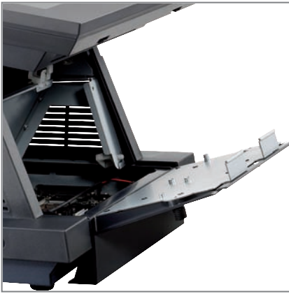
EINFACHER ZUGANG zu Festplatte & Hauptplatine
